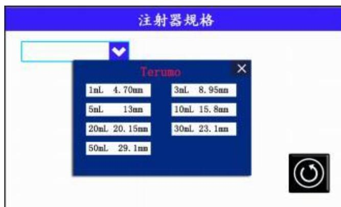
图 6 注射器规格选择界面
